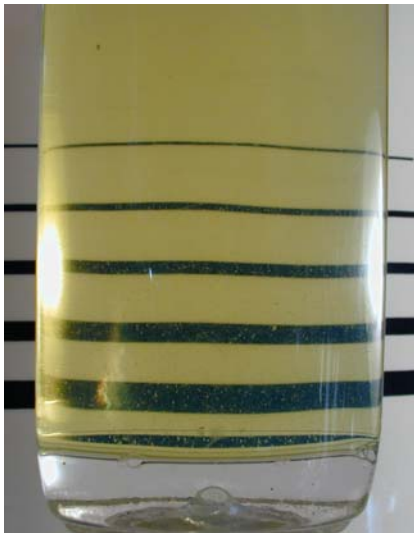
Diesel med frit vand på bunden
