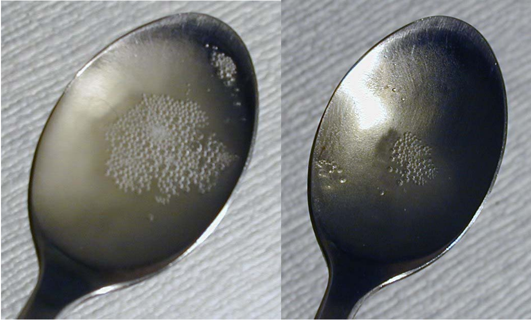
Olien skummer ved opvarmning. Vandet er dampet væk, olien bliver klar
