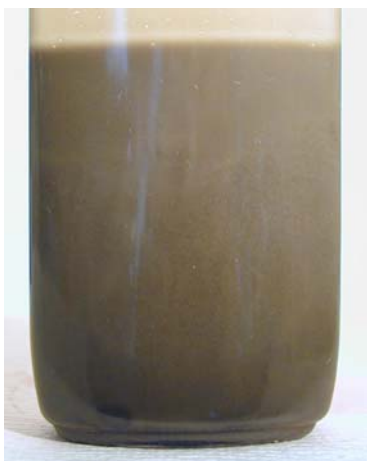
Motorolie med højt vandindhold
